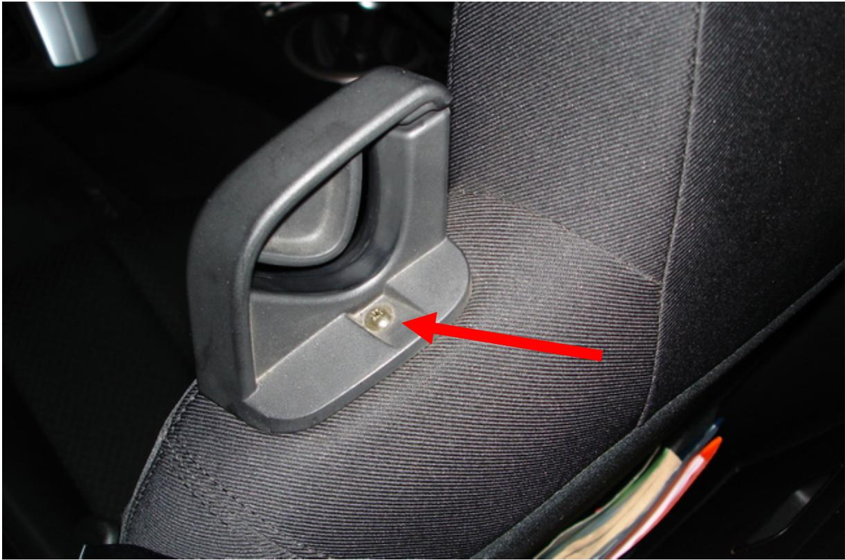
**Bild 6: Die Gurtführung wird nach oben abgezogen. Die Ansicht gilt für alle 4 Varianten der Gurtführung.**
