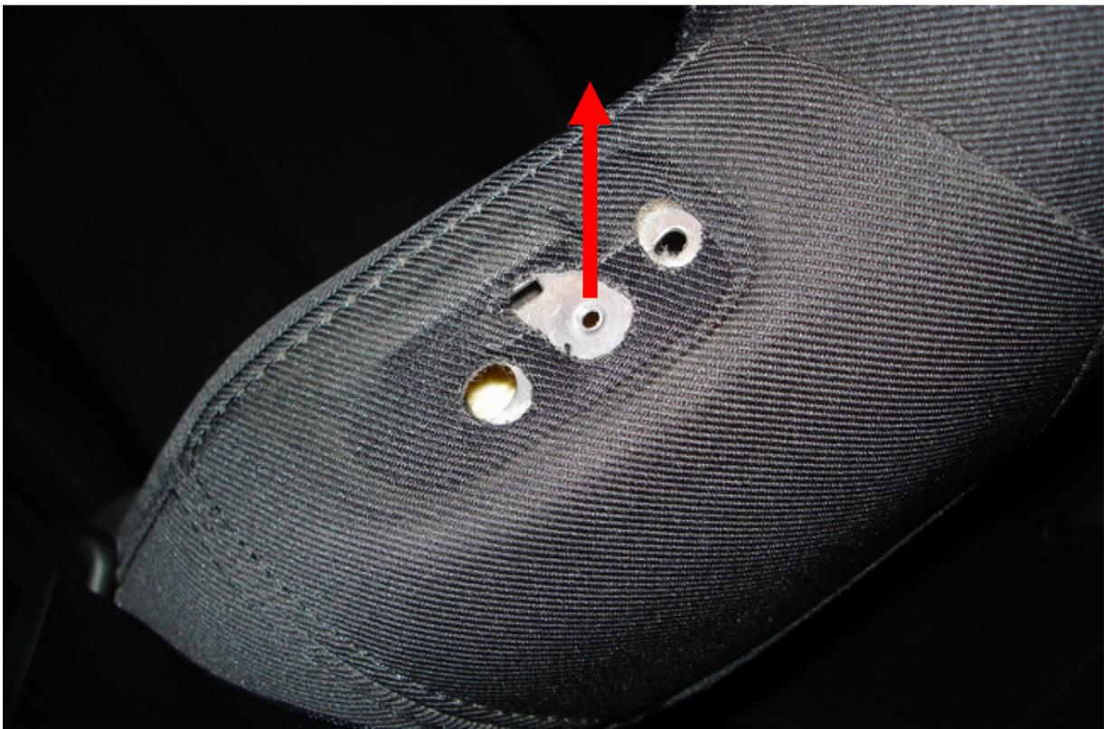
**Bild 7: Aus der alten Gurtführung wird die metallene Verstärkerplatte entnommen, sie kann mit den Händen herausgezogen werden. Ggf. kann man mit dem Schraubendreher ganz leicht hebeln. Diese Verstärkerplatte wird einfach in die neue Gurtführung geschoben.**
